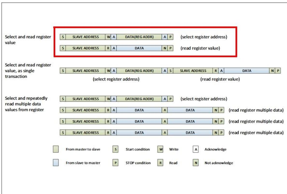
Abbildung 8: Lesen von einem Peripheriebaustein
