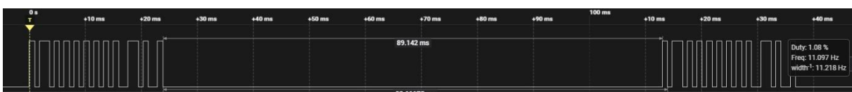
Abbildung 7: Taste 9 - feuert mit 90\text{ms} Pause zweimal
