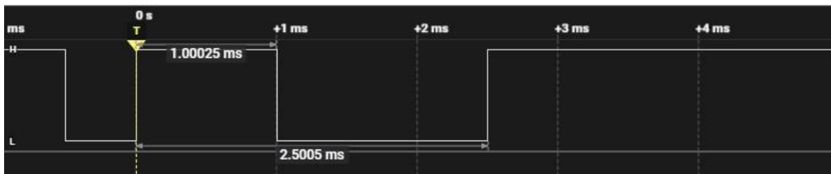
Abbildung 6: 500-1000-1500-2000 an GPIO27 mit idle_level=1+data=0
