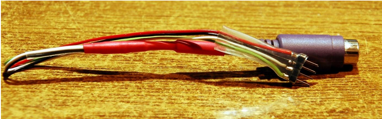
Abbildung 3: PS2 Tastaturanschluss fürs Breadboard
