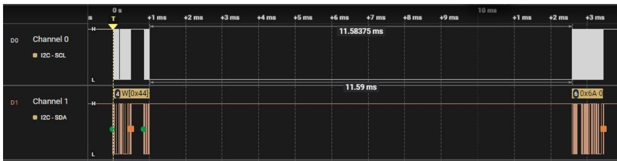
Abbildung 5: Clock-Stretching im Überblick
