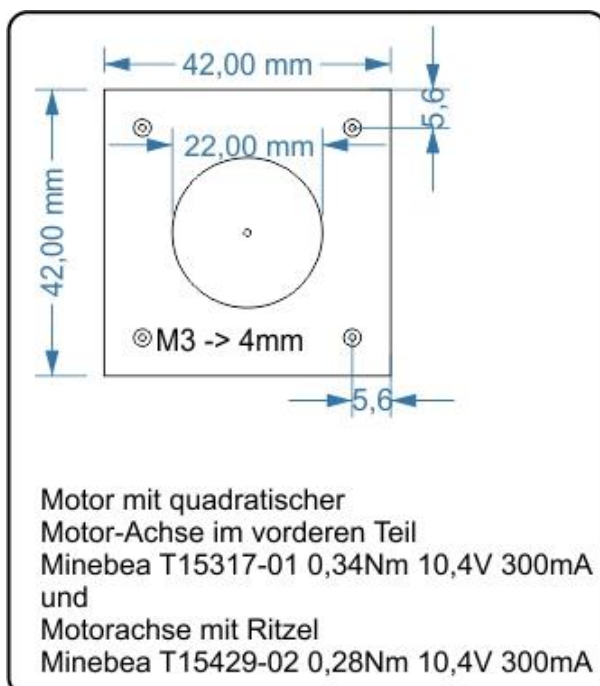
Abbildung 2: Bohrungen für die Motoraufnahme
