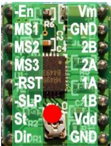
Abbildung 4: A4988 - Pinout
