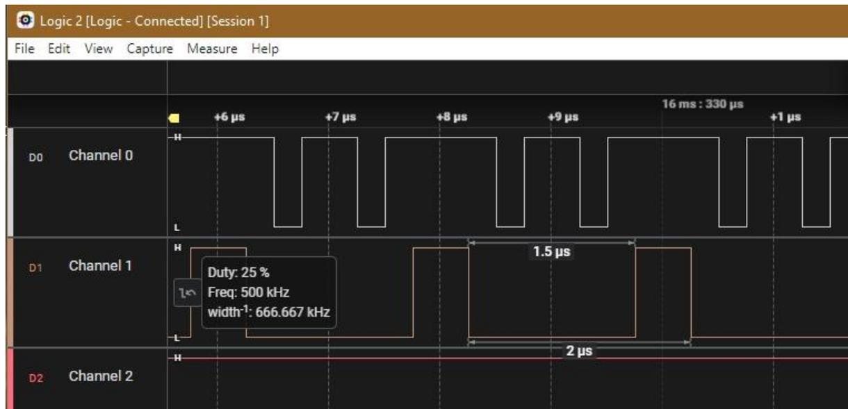
Abbildung 33: Ermittlung des Timings mit dem Logic Analyzer
