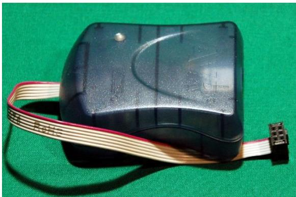
Abbildung 2: AVR-MK II Programmer von ATMEL
