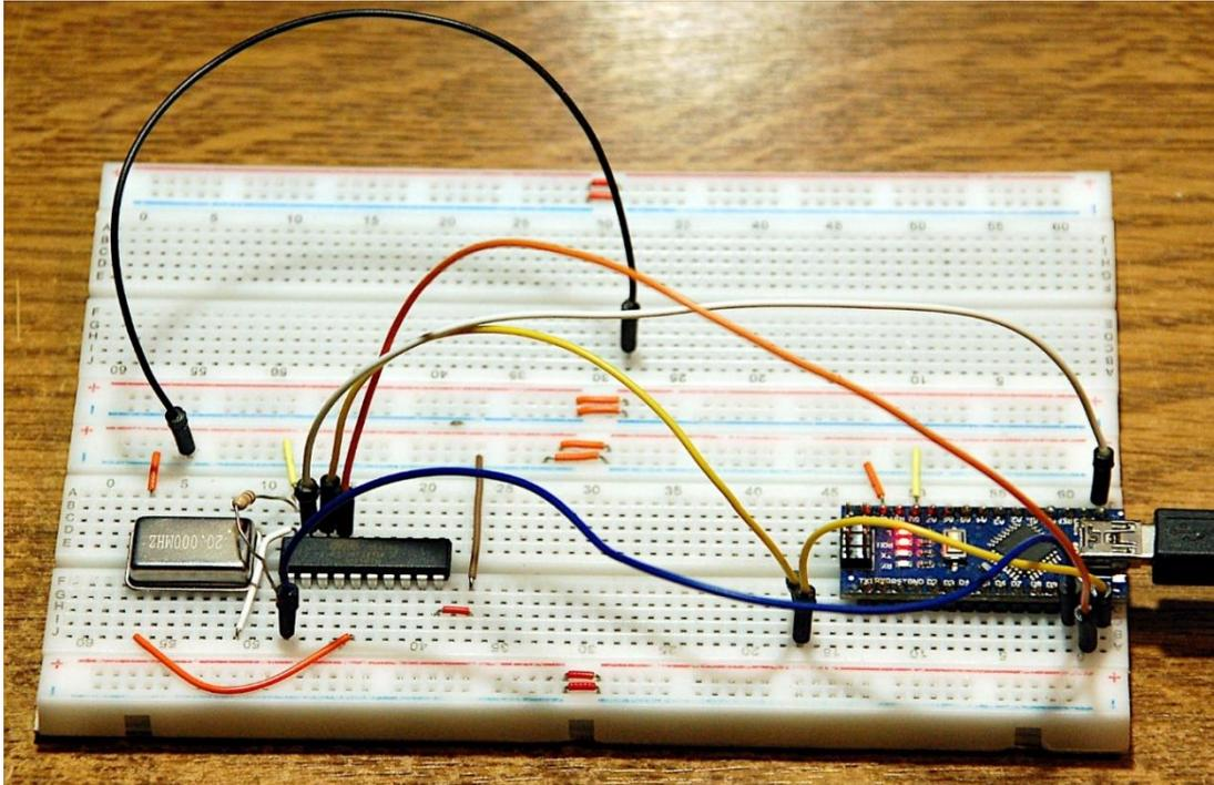
AT-Tiny2313 am Arduino-Programmer
