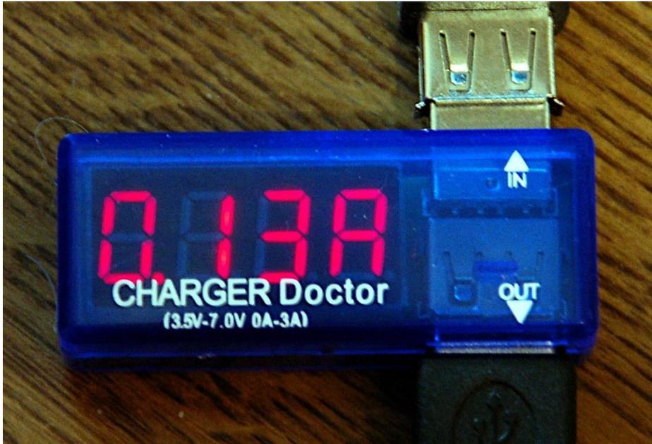
Abbildung 9: Strommessung am USB mit dem Charger Doctor
